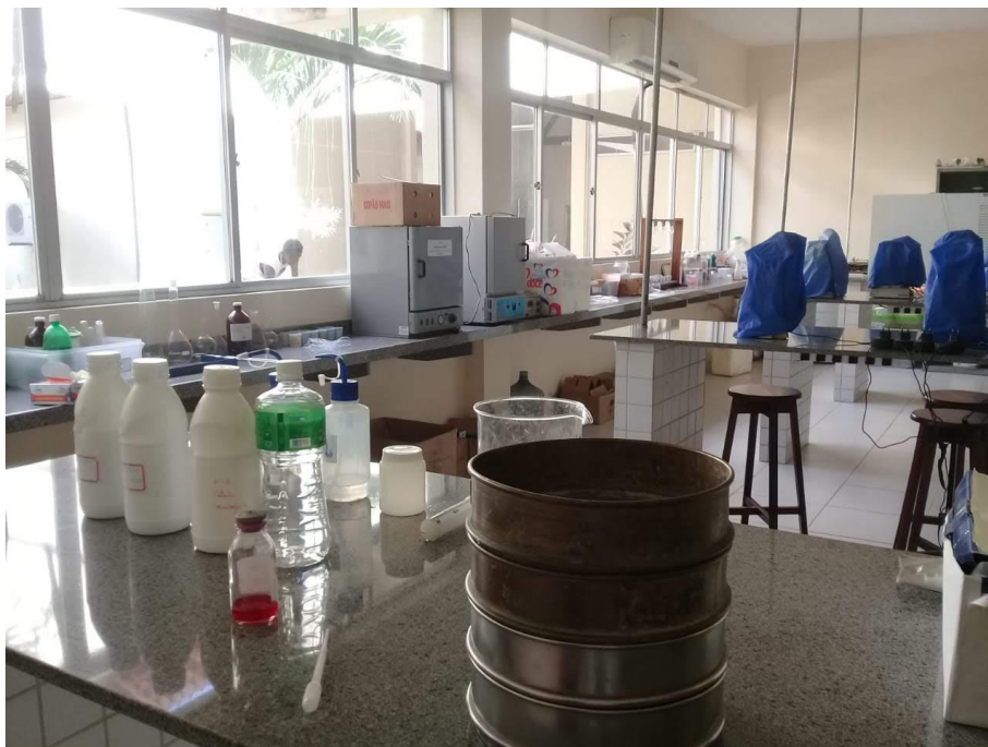
Figura 5.2.4.2-4: Material em laboratório e peneiras em que foram analisadas as amostras de sedimento. Fonte: SABIO, 2019.
