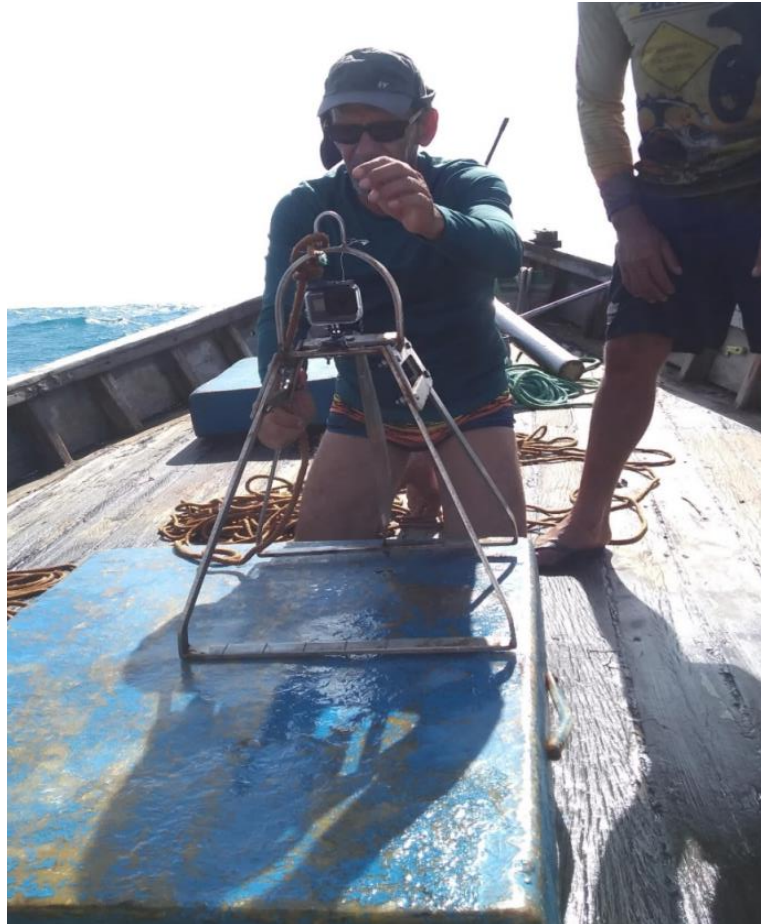
Figura 5.2.5.3-2: Equipamento utilizado para registros fotográficos e vídeo subaquático remoto (BRUV) na área. Fonte: BIOMAR, SABIO, 2019.
