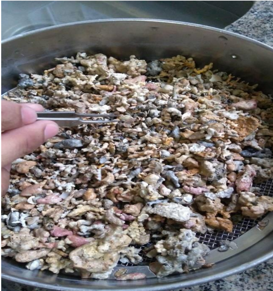
Figura 5.2.4.2-5: Material sendo triado em peneiras granulométricas de malha 0.05mm. Fonte: SABIO, 2019.
