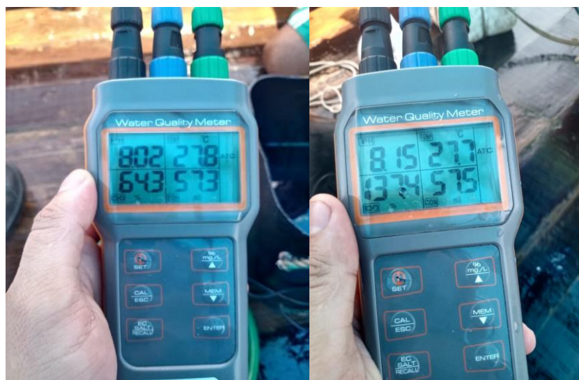
Figura 5.1.6-4: Coleta de dados sonda ponto 1 (Esquerda superfície e Direita fundo). Fonte: BIOMAR, 2020.
