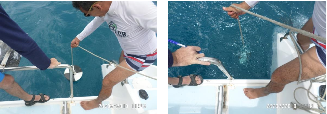
Figura 5.1.5.3-1: Detalhe de Medição de Transparência Secchi. Primeira campanha. Fonte: BIOMAR, 2018.
