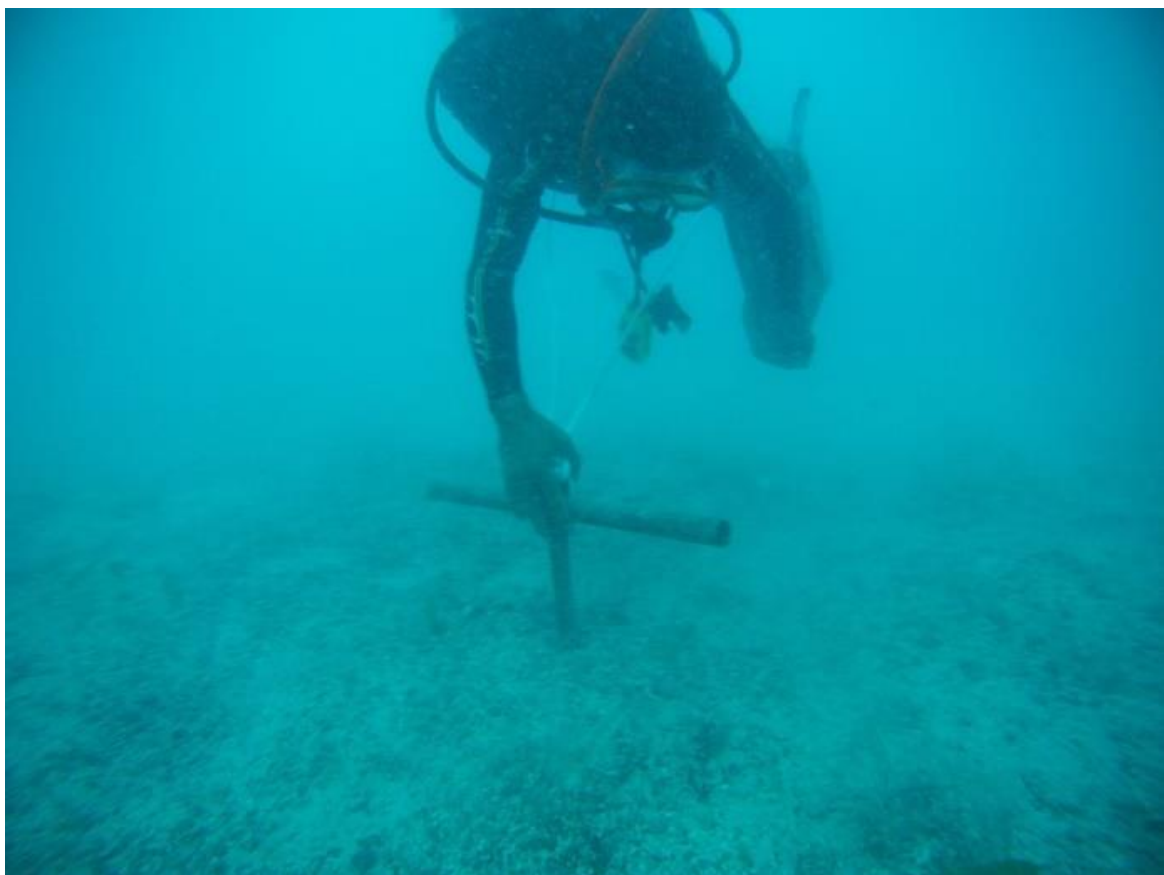
Figura 5.1.4.6-5: Mergulho para sondagem a trado manual. Fonte: BIOMAR, 2018.
