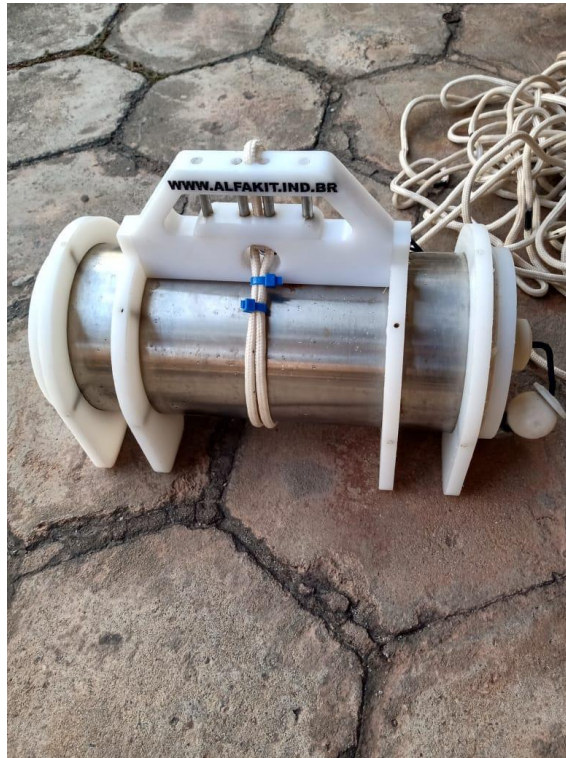
Figura 5.1.6-3: Garrafa Van Dorn 2L utilizada em campo Fonte: BIOMAR, 2020.
