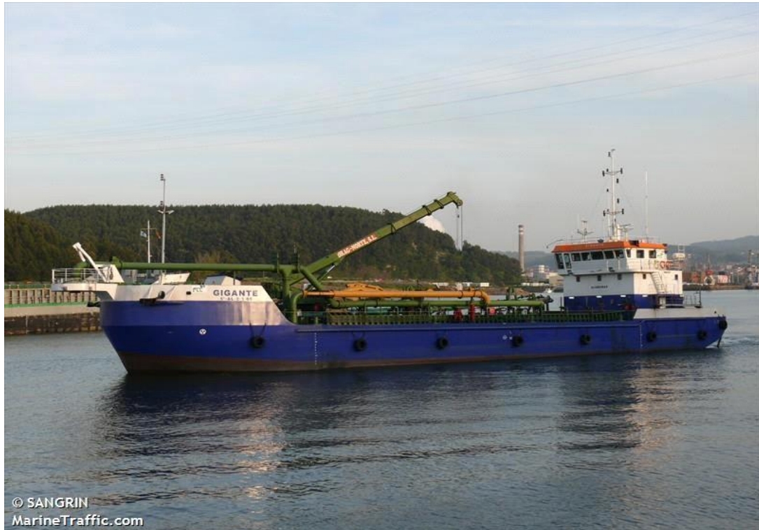
Figura 3.3.3.1-1: Exemplo de embarcação do tipo Hopper. Fonte: https://google.com.br/search/sourceUUjwdZ0w5bnYtM . Acesso em 31/07/2020.
