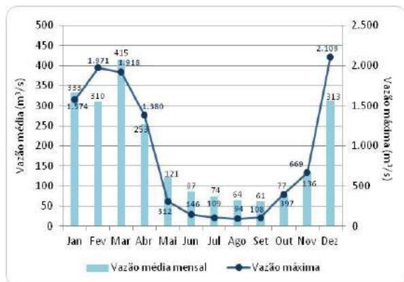
Figura 6.2.4-16 - Vazões na estação Nova Roma, para o período de 1984 a 2006, com falhas. Fonte: ANA, 2015
