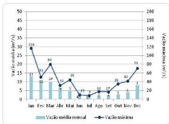
Figura 6.2.4-24 - Vazões na estação Bom Sucesso, para o período de 1984 a 2009, com falhas. Fonte: ANA, 2015
