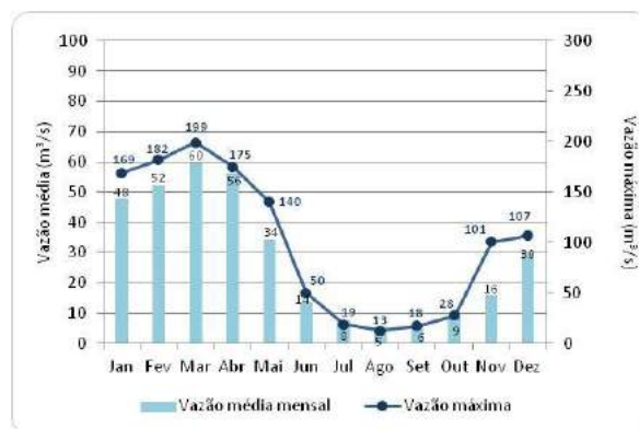
Figura 6.2.4-13 - Vazões na estação Arapoema, para o período de 1986 a 2007, com falhas. Fonte: ANA, 2015
