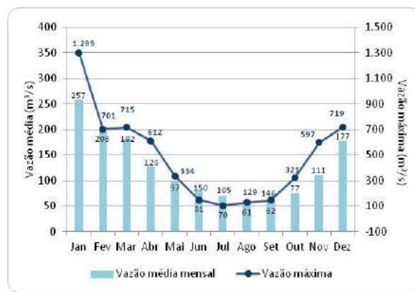
Figura 6.2.4-25 - Vazões na estação Ibituruna, para o período de 1984 a 2009, com falhas. Fonte: ANA, 2015
