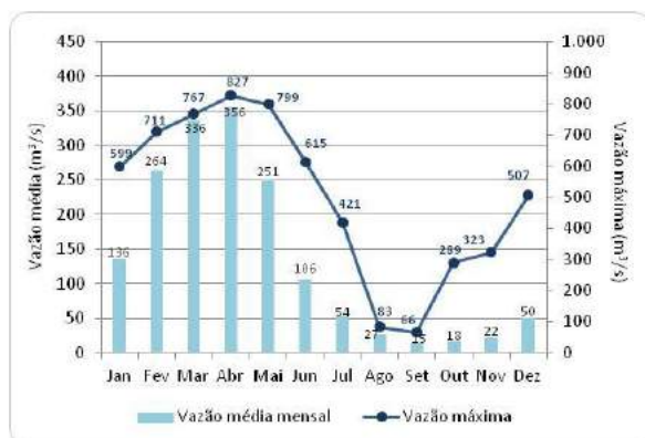
Figura 6.2.4-12 - Vazões na estação Pacajás, para o período de 1984 a 2014, com falhas. Fonte: ANA, 2015
