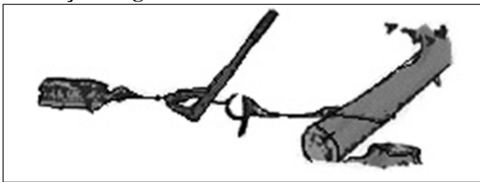
Figura 6 Utilização do guincho manual no redirecionamento da queda da árvore
