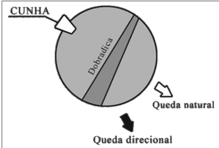
Figura 5 Redirecionamento da queda da árvore por meio da adoção de cunha e assimetria na largura da dobradiça
