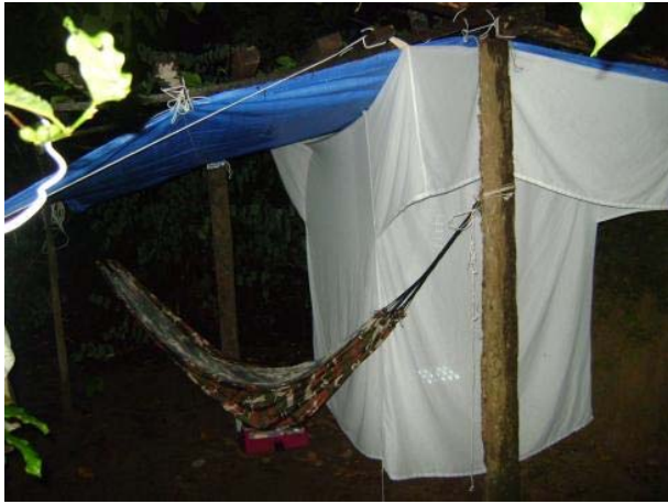
Foto 55: Armadilha de Shannon utilizada nas coletas de anofelinos adultos. Montada antes do crepúsculo tem como fatores de atração a luz artificial e a presença humana.
