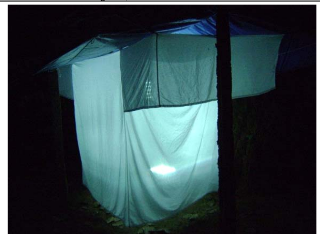
Foto 54: Armadilha de Shannon em operação utilizada nas coletas de anofelinos adultos. Seu interior representa o intradomicílio e suas abas e partes externas o peridomicílio. Tem a propriedade de atrair mosquitos antropofílicos, pela presença humana do coletor. É dotada de iluminação artificial.
