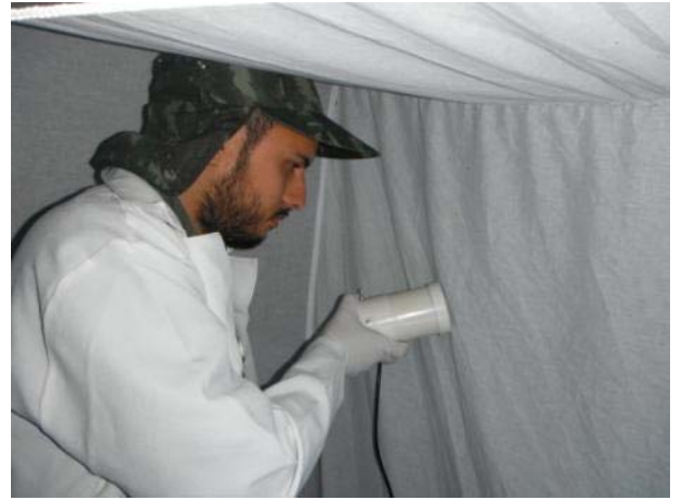
Foto 56: Armadilha de Shannon em operação e mostrada em sua parte interna. O coletor, no interior da armadilha, executa a coleta utilizando-se de um aspirador elétrico portátil, movido a bateria de 6 volts. O material biológico obtido é separado segundo as horas de coleta, prestando-se essa técnica para a aferição do ritmo horário das espécies.
