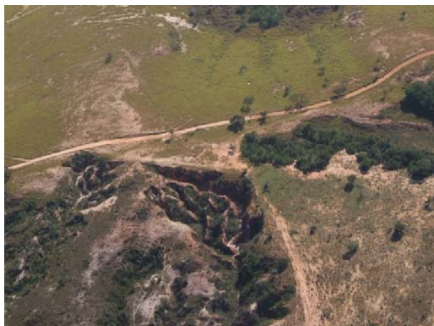
Fotos 255 e 256: Boçorocas de alta intensidade e processos de erosão laminar e em sulcos de ocorrência generalizada em cabeceira de drenagem de Terrenos Colinosos, a sul do Vértice JGP MV-92B (Faixa 26).
