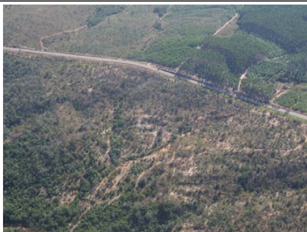
Fotos 251 e 252: Terrenos Colinosos com processos intensos de erosão laminar, em sulcos e formação de boçorocas frequentes e de alta intensidade, que conferem ao trecho entre Vértices JGP MV-91 e JGP MV-92C, Sensibilidade Geoambiental Alta (Faixa 26).
