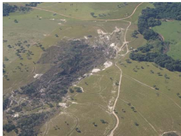
Fotos 291 e 292: Processos de erosão superficial e em sulcos, boçorocas e reentalhe de drenagem que ocorrem na zona de contato entre terrenos Colinosos e os terrenos Amoreados, nas proximidades do Vértice MV-103 (Faixa 28).
