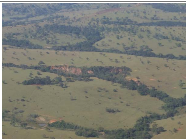
Fotos 269 e 270: Boçorocas, erosão laminar e em sulco de alta intensidade e ocorrência ocasional em terrenos Colinosos, nas proximidades do Vértice JGP MV-101 (Faixa 27).
