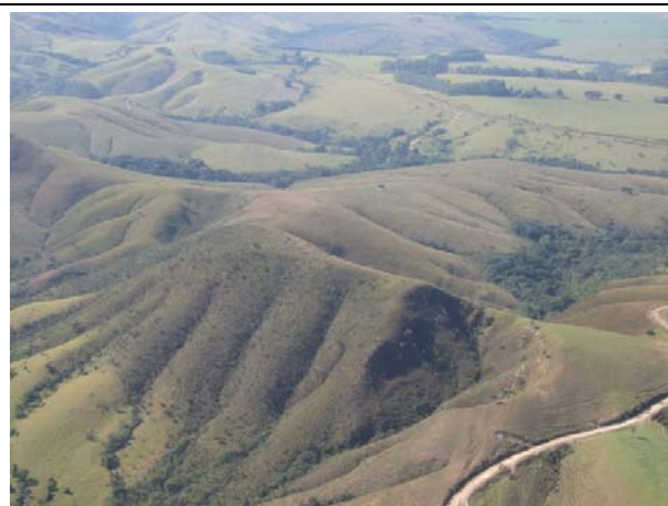
Fotos 275 e 276: Encosta com declividades de 15 a 45%, sujeitas a processos de erosão laminar, em sulcos ocasionais a frequente de média a alta intensidade, rastejo e entalhe de drenagem generalizados de média a alta intensidade, movimentos de massa do tipo: escorregamento planar e queda de blocos ocasionais de média a alta intensidade, que caracterizam os Terrenos Amorreados que ocorrem entre os Vértices JGP MV-101A e MV-102 (Faixa 28).
