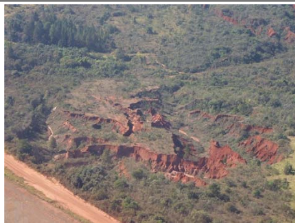
Fotos 287 e 288: Boçorocas de alta intensidade que se desenvolvem nas cabeceiras de drenagem dos terrenos Aplanados, ocorrendo geralmente nas proximidades do contato com os terrenos Amorreado (Faixa 28).
