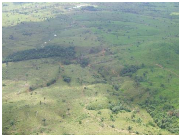
Fotos 27 e 28: Vales erosivos mais encaixados e dissecados que caracterizam setores dos terrenos Colinosos onde as encostas apresentam inclinações de 8 a 15 %, nas proximidades do Vértice V1-28 (Faixa 4).
