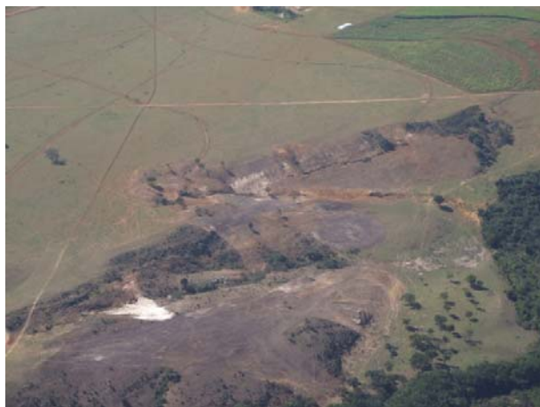
Fotos 291 e 292: Processos de erosão superficial e em sulcos, boçorocas e reentalhe de drenagem que ocorrem na zona de contato entre terrenos Colinosos e os terrenos Amoreados, nas proximidades do Vértice MV-103 (Faixa 28).
