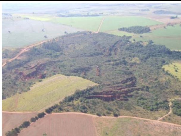
Fotos 287 e 288: Boçorocas de alta intensidade que se desenvolvem nas cabeceiras de drenagem dos terrenos Aplanados, ocorrendo geralmente nas proximidades do contato com os terrenos Amorreado (Faixa 28).
