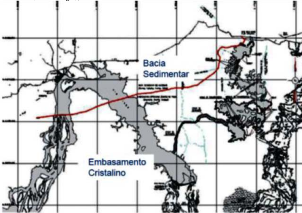
Figura 4.3.2.b Limite entre o Embasamento Cristalino e a Bacia Sedimentar na Área de Volta Grande (Rio Xingu), onde está localizado o Reservatório de Belo Monte
