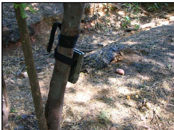
Figura 9.3.2-103 - Armadilhas fotográficas utilizadas para levantamento da fauna na LT São João do Piauí - Milagres
