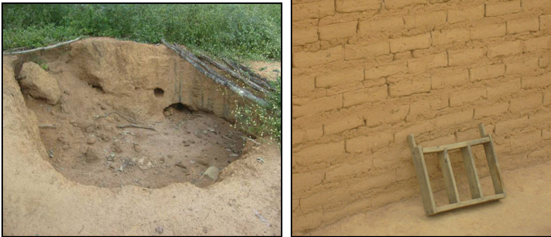
Figura 9.4.2-28 - Local de Retirada do Barro para Fabricação do Adobe e Paredes e Fôrmas de Madeira para Confecção do Adobe
