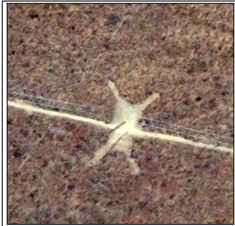
Figura 6-10 - Exemplo de torres estaiada instalada com mínima supressão de vegetação
