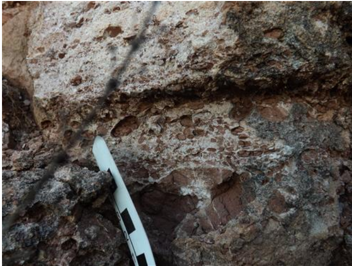
Foto 8.1.3-9 – Conglomerado com arcabouço constituído por seixos de arenitos arredondados e sustentado por matriz arenosa com cimentação carbonática e silcrete
