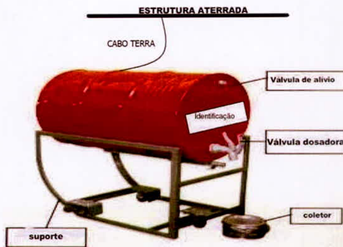
Figura 3 – Modelo de tambor para armazenamento de inflamáveis
