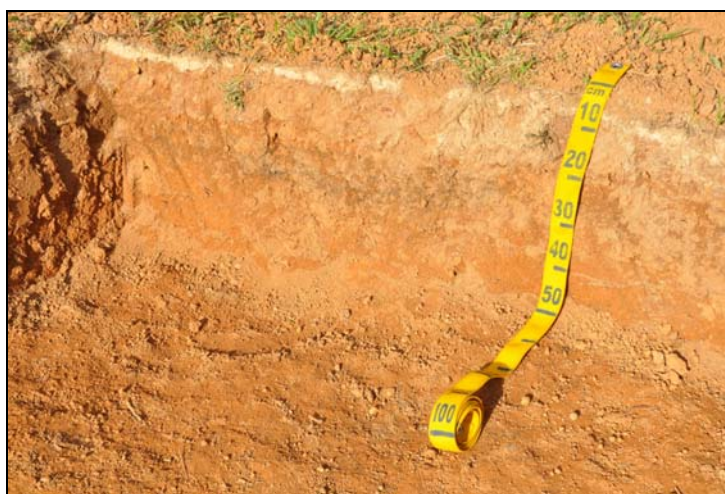
Figura 3.6.3.6.2-4: Perfil de Latossolo Vermelho-Amarelo no trecho 2 entre os rios das Garças e o Jaci Paraná. Fonte: NEPUT, 2010.
