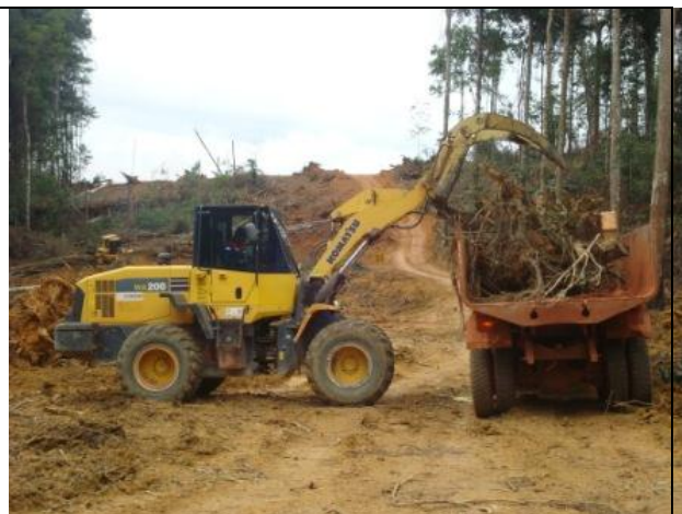
Foto 8-7 – Carregadeira de garfo utilizada para empilhamento de material lenhoso
