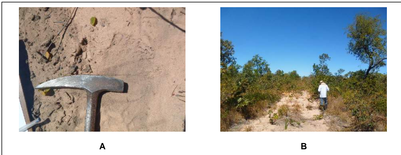
Figura 92 - (A) Solo em detalhe. Visada para zênite. (B) Visada para Az= 150°. Acesso secundário e ao entorno mata arbórea e arbustiva de cerrado. Área aplainada em topo de platô, recoberta por sedimentos arenosos com ausência de processos do meio físico, indicando baixa suscetibilidade geotécnica. Não observados afloramentos ou feições indicativas da presença de cavidades, indicando ocorrência improvável de potencial espeleológico. Fotos: GEOEMP.
