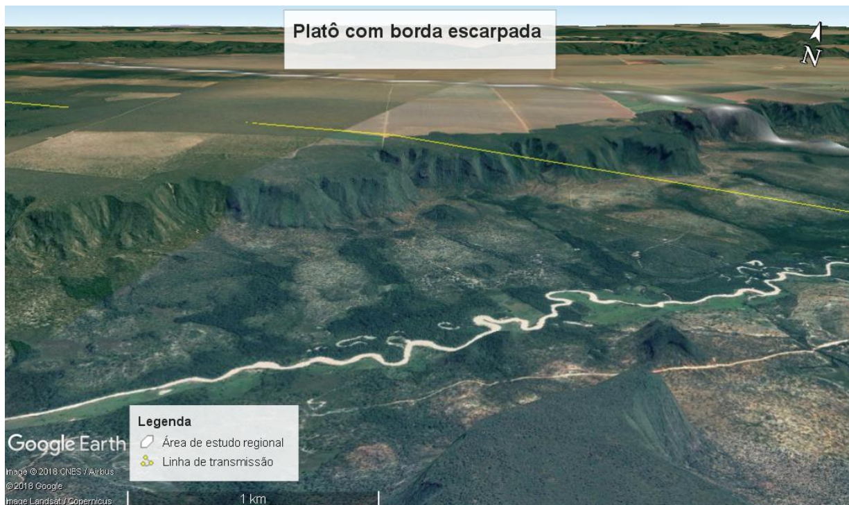
Figura 7.2-103 – Exemplo de borda erosiva a escarpada de platô identificadas em imagens aéreas ao longo da LT.
