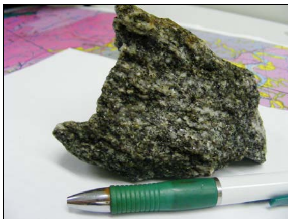
Figura 3.6.3.3-9 - Granito Pão de Óleo. Observa-se bem a textura granoblástica e a granulometria do tipo "sal grosso"
