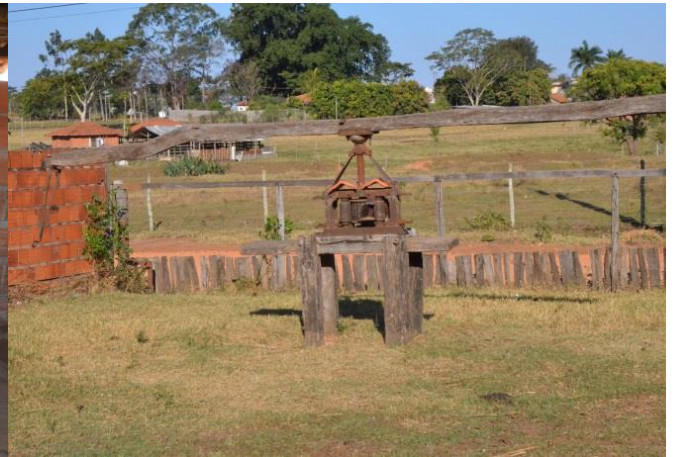
Figura 41: Moenda, utilizada na produção de melado e rapadura.
