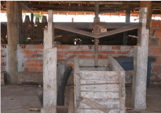
Figura 40: Prensa utilizada na produção de polvilho
