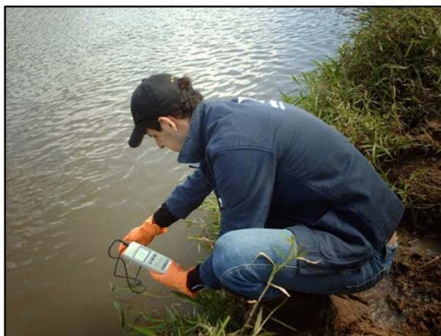
**Figura 67. Medição *in situ* de condutividade elétrica.**
