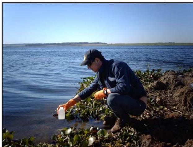
**Figura 68. Coleta de água para análise bacteriológica.**
