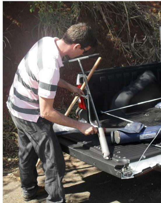
Figura 2. Montagem do trado para prospecção de solo.
