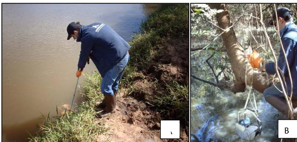
**Figura 69. Coleta de zoobentos com amostrador do tipo “Dip net” (A) e com uma draga do tipo “Petit ponar” (B).**
