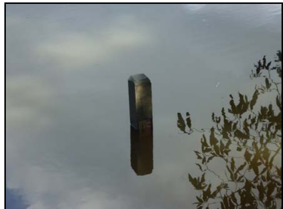
Figura 4-9 - 4ª Régua limnimétrica da rede hidrometeorológica da Agência Nacional de Águas (ANA) para medição da cota de inundação do Rio Alalaú localizada nas proximidades da ponte da BR-174 praticamente submersa 28/07/13.
