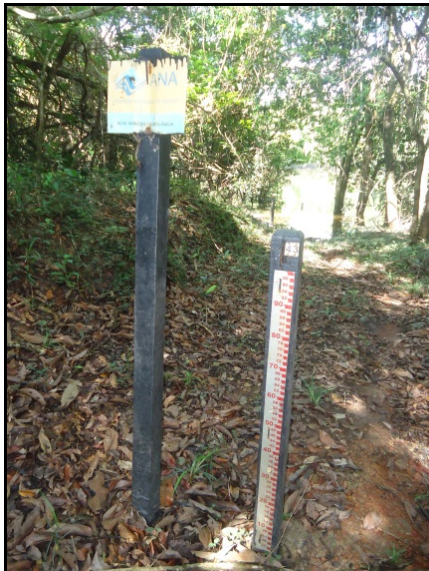
Figura 4-8 - 1ª Régua limnimétrica da rede hidrometeorológica da Agência Nacional de Águas (ANA) para medição da cota de inundação do Rio Alalaú localizada nas proximidades da ponte da BR-174 em cota seca em 28/07/2013
