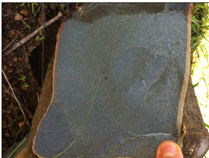
Figura 3.6.3.3-17 - Detalhe da amostra de basalto da Formação Apoteri da Bacia do Tacutu.
