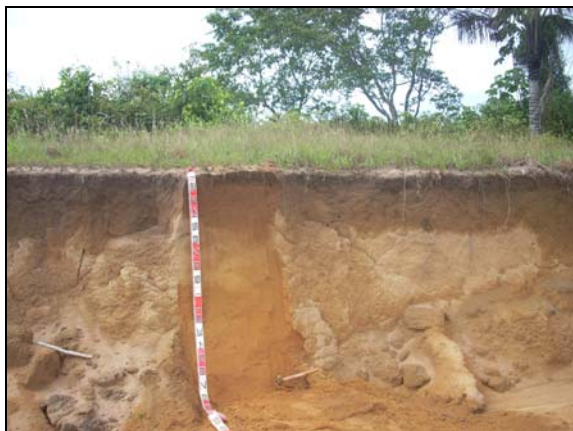
Foto 43 - Área de Latossolo Amarelo distrófico, textura média, desenvolvido em relevo suave ondulado, relevo de colinas amplas da formação Alter do Chão, ocupados com cerrado. UTM 198266/9828924.
