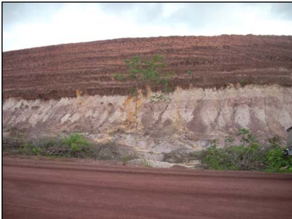
Foto 15 - Corte de estrada em relevo de colina, com Latossolo em superfície e camada de plintita em subsuperfície (plintite), em área de floresta. UTM 437503/0016812.
