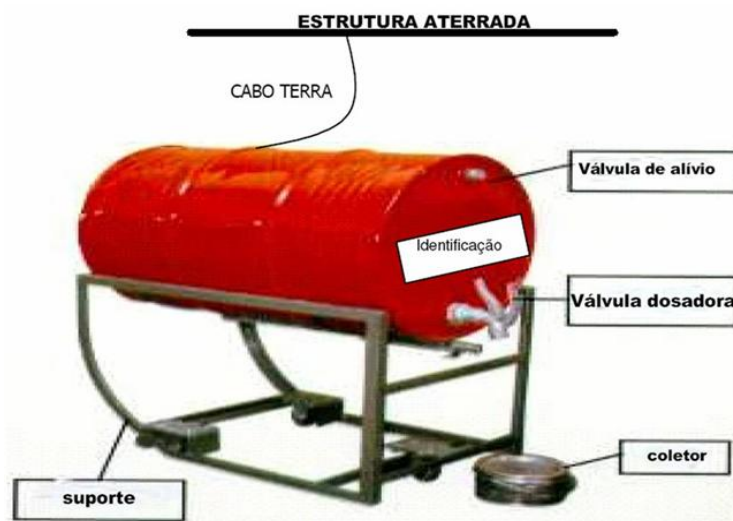
Figura 11 – Modelo de tambor para armazenamento de inflamáveis
