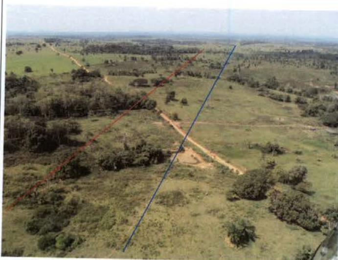
Foto 95: a LT existente utilizou uma ilha p/ instalação de torre e diminuição do vão de travessia do rio Ji-Paraná. A presença de fauna deverá subsidiar solicitação de desvio da nova Linha.
