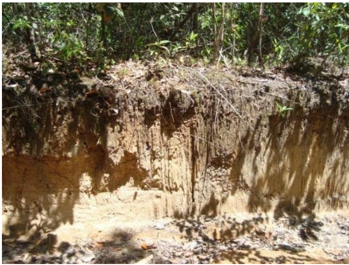
Foto 3.6.4-70 – Perfil do solo, mostrando seu padrão argilo-arenoso no ponto PF15.
