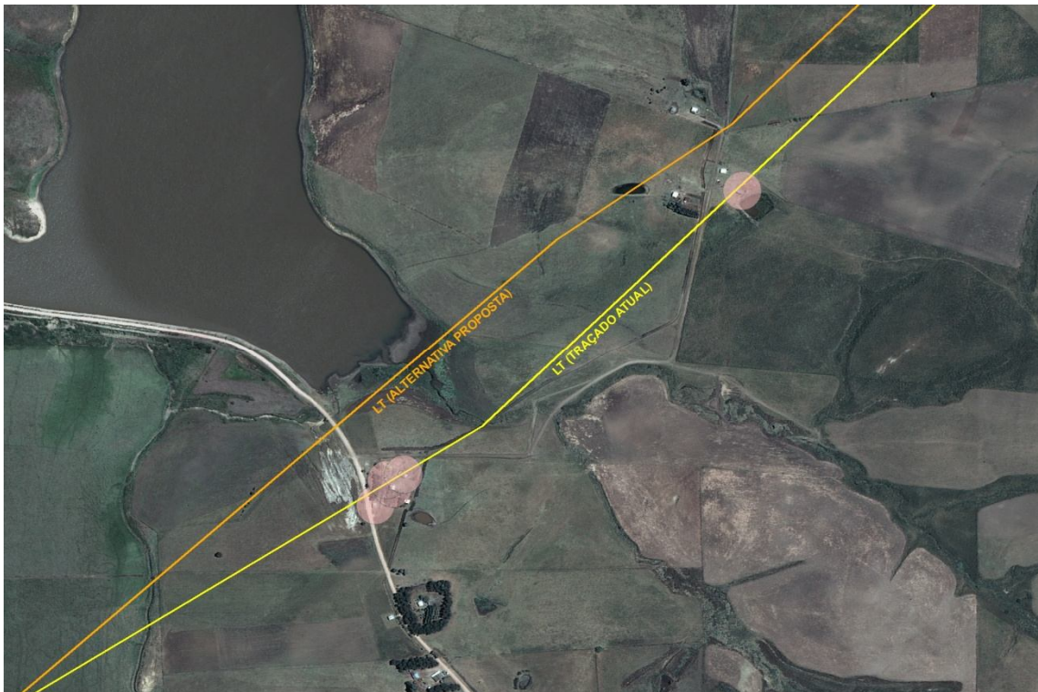
Figura 3. Imagem Orbital Quickbird 2010 ilustrando a proposição de pequena alteração no traçado atual da LT 525 kV situada km 28 aproximadamente.
