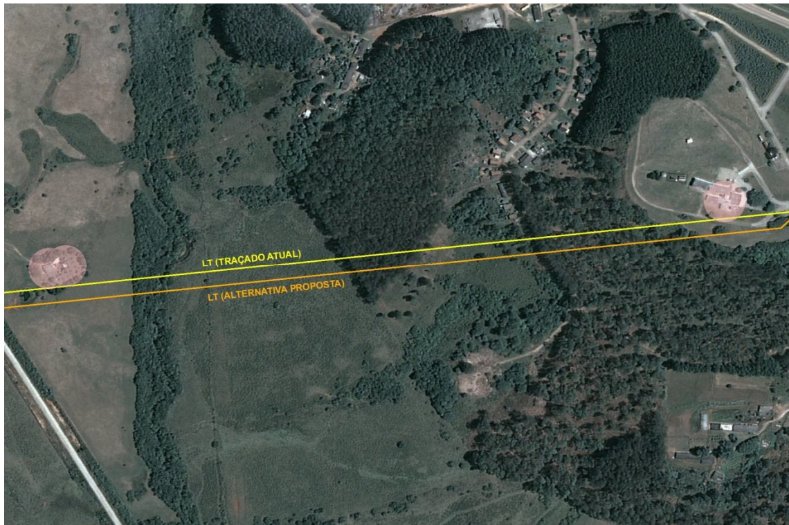
Figura 1. Imagem Orbital Quickbird 2010 ilustrando a proposição de pequena alteração no traçado atual da LT 230 kV situada no km 01 aproximadamente.
