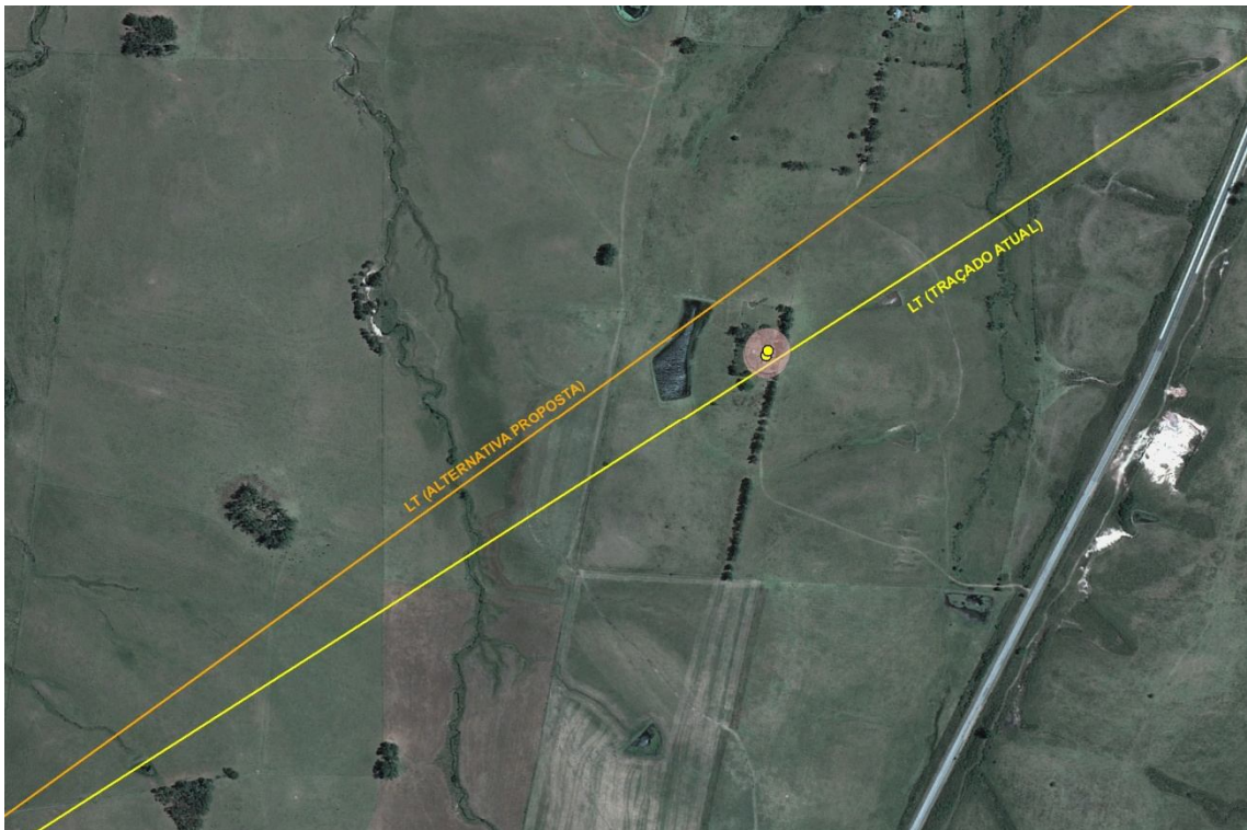
Figura 5. Imagem Orbital Quickbird 2010 ilustrando a proposição de pequena alteração no traçado atual da LT 525 kV situada km 58 aproximadamente.
