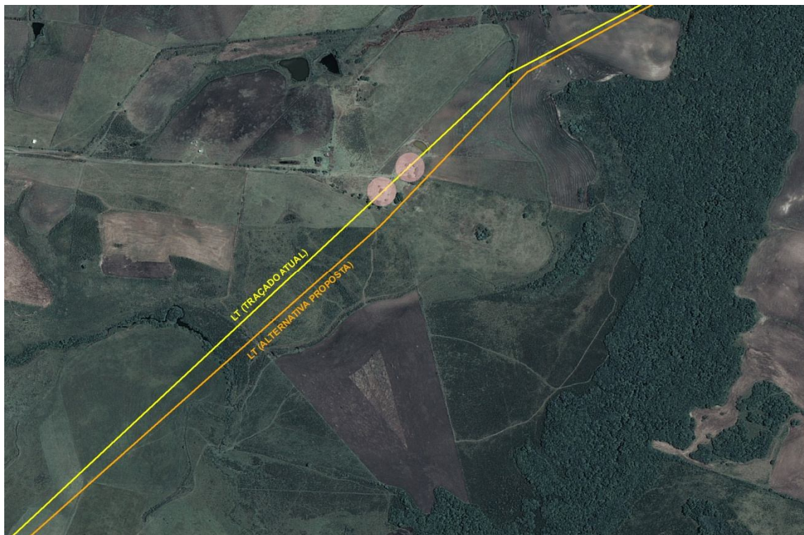
Figura 2. Imagem Orbital Quickbird 2010 ilustrando a proposição de pequena alteração no traçado atual da LT 525 kV situado no km 22 aproximadamente.
