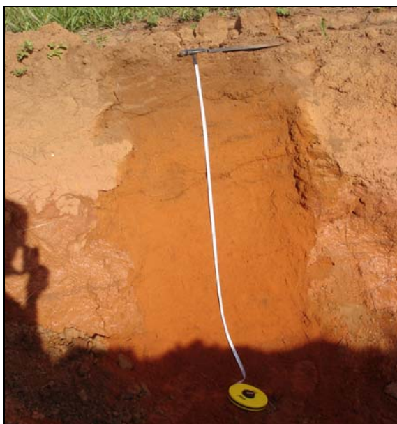
Figura 3.6.3.6-9 - Perfil de Latossolo Vermelho Amarelo distrófico, A moderado, textura argilosa, relevo plano/suave ondulado, em associação com Latossolo Vermelho distrófico. UTM 340500 / 8174140.
