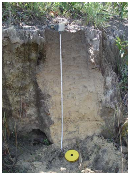
Figura 3.6.3.6-17 - Perfil de Neossolo Quartzarênico Órtico, A moderado, relevo suave ondulado. Perfil aberto em corte de estrada, em local de fluxo concentrado em sulco erosivo, evoluindo para ravina. Litologia: arenito da Formação Furnas. UTM 369724 / 8168221.
