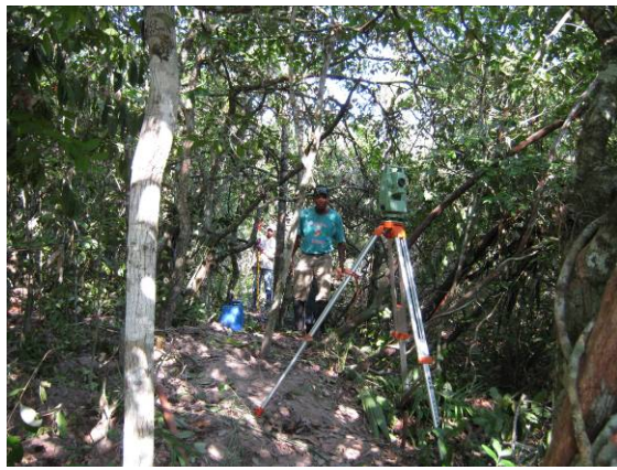
Foto 3.6.4.4-13: Detalhe do teodolito utilizado na instalação da parcela de 250m nível (M3). Coordenada X 784.178,735 / Y 8.482.211,620
