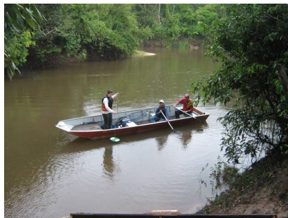
Foto 3.6.4.4-628: Análise de transparência da água (disco de secchi).
