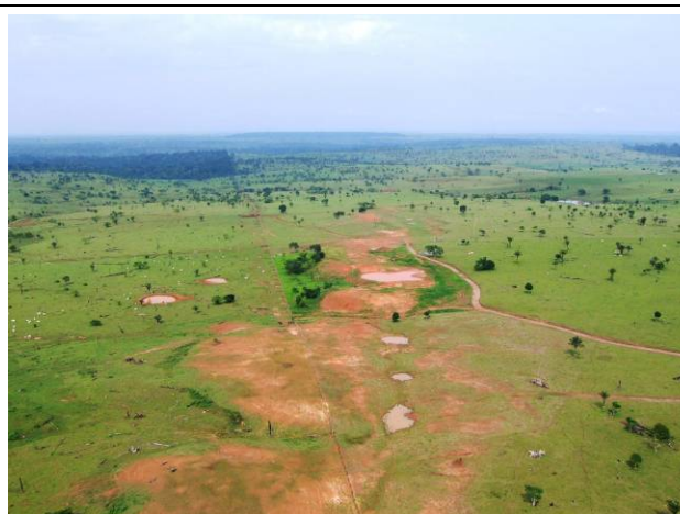
Foto 3.6.3.5-52 – Colinas amplas: terreno pouco sensível a interferências, com problemas localizados devido à erodibilidade dos solos arenosos.
