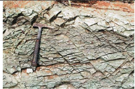
Foto 3.6.3.2-50 - Ponto 098: pormenor de intenso microfaturamento afetando os lamitos da Formação Corumbataí, ilustrados na foto anterior; no leito do córrego existem vários blocos de diabásio com até um metro de diâmetro.
