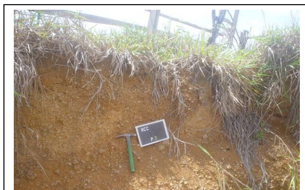
Foto 3.6.3.6-2 – Perfil de PLINTOSSOLO PÉTRICO Concrecionário típico, textura argilosa, sob floresta. Ocorrência significativa nas proximidades de Porto Velho junto a LATOSSOLOS AMARELOS. Coordenadas E9.011.024 e N404.309.
