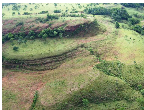
Foto 3.6.3.5-18 – Relevo de Morros suaves e Morrotes tabulares: vertente de perfil contínuo retilíneo suave nos morros e descontínuo com rupturas de declive. Vales erosivos encaixados e abertos com canais em rocha.
