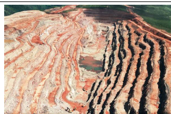
Foto 3.6.3.2-72 - Ponto 183: mina de ouro da Yamana em metapelitos do Grupo Aguapeí, com teores de ouro da ordem de 0,5 g/ton ou menos, resultando em grandes volumes de rejeito estéril; a mina situa-se fora da AII da LT, cujo traçado atravessa a mesma crista sustentada pelo Grupo Aguapeí, cerca de 5 km a sudoeste da área da mina.
