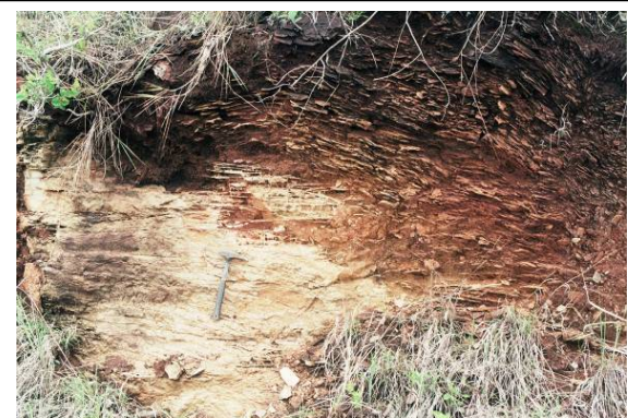
Foto 3.6.3.2-94 - Ponto 192: minério aflorante de níquel com formações tipo "chapéu de ferro" e presença localizada de garnierita preenchendo as fraturas.
