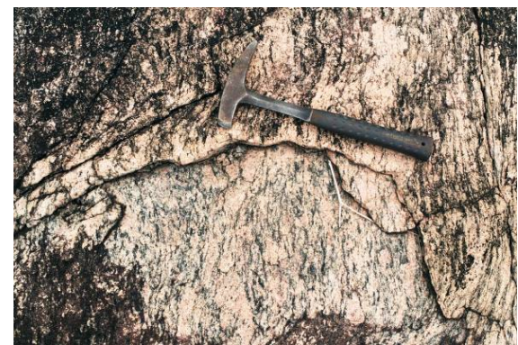
Foto 3.6.3.2-82 - Ponto 229: pormenor da estrutura do gnaiss facoidal grosso, vendo-se xenoblastos feldspáticos rosados contornados por minerais máficos da matriz mais fina.
