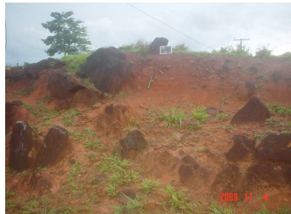
Foto 3.6.3.6-6 – Perfil de ARGISSOLO VERMELHO-AMARELO Distrófico típico, textura média/argilosa, fase rochosa, sob floresta. Próximo Jaru (RO). Coordenadas E8.848.842 e N554.011.
