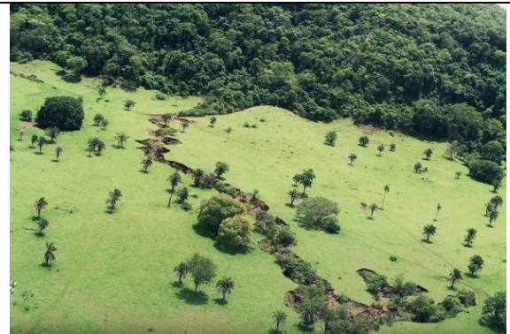
Foto 3.6.3.2-26 - Ponto 072: voçorocamento desenvolvido no domínio da Formação Vale do Rio do Peixe, a partir de surgência de água, no sopé de escarpa florestada em arenitos calcíferos da Formação Marília.
