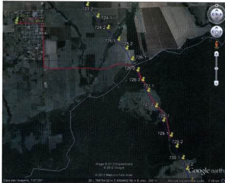
Ilustração A: Rota da vistoria realizada no dia 06/11/2012, em vermelho. Em azul, traçado da LT n° 2. Pontos em amarelo demonstram as coordenadas das bases das torres. Pontos em verde indicam a áreas destinadas aos canteiros de obra da IE Madeira (LT n° 1) e Norte Brasil (LT n° 2) em Cabixi/RO. Em cinza, curso do rio Cabixi.
