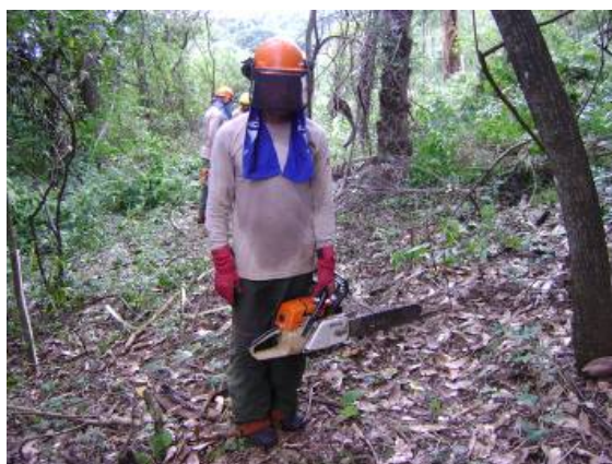
Foto 2.5-9 – Motosserrista usando Equipamentos de Proteção Individual (EPIs) necessários para a atividade (outra LT).
