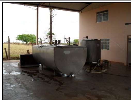
Foto 3.6.5.11 - 200 - Tanque de expansão para o recebimento de leite.
