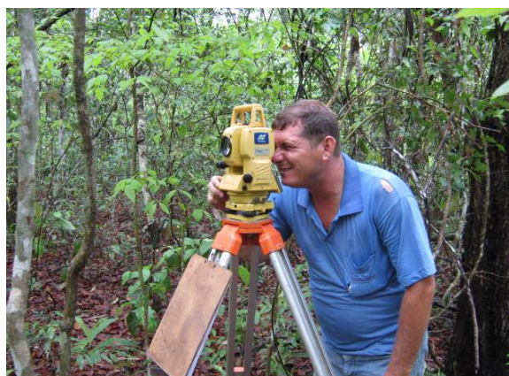
Foto 3.6.4.4-15: Utilização de teodolito pela equipe de topografia durante a instalação da parcela de 250 metros em nível.
