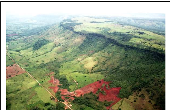
Foto 3.6.3.2-109 - Ponto 350: platô residual com superfície de pediplanação preservada em cobertura sedimentar da Formação Utirariti, no domínio de rochas da Suíte Intrusiva Cachoeirinha; no sopé da escarpa observam-se solos avermelhados expostos, indicando espessuras grandes de solos de cobertura (residuais ou coluviais).
