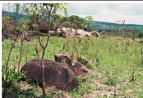
Foto 3.6.3.2-87 - Ponto 130: matacões grandes de granito grosso leucocrático (Granito São Vicente), com raros pósfiros de feldspato de dimensões centimétricas, e grãos de quartzo ultrapassando 1mm.
