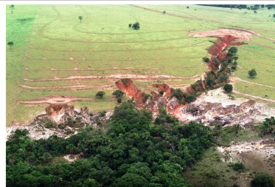
Foto 3.6.3.2-46 - Ponto 400: área com várias voçorocas na margem de drenagem, que se encontra assoreada, no domínio da Formação Botucatu.
