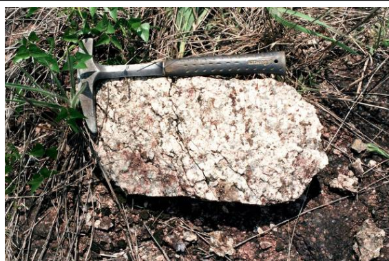
Foto 3.6.3.2-81 - Ponto 276: pormenor da textura de granito grosso alterado e aspecto de laje rochosa no topo de morro, com exposições extensas da Suíte Intrusiva Rondônia (granito, granitóide quartzoso, monzo-granito, sienito, albíta-granito).
