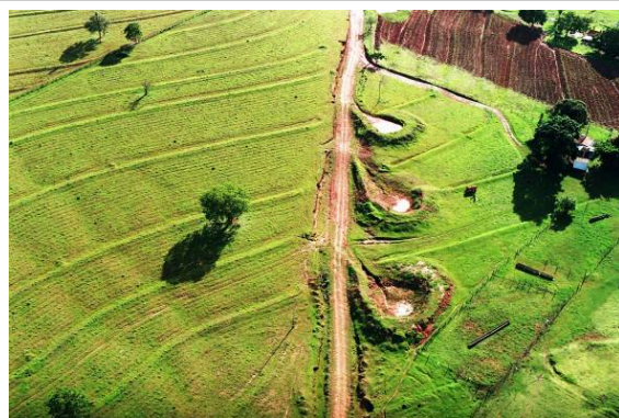
Foto 3.6.3.2-38 - Ponto 433: caixas de coleta de água de chuva para evitar erosão ao longo de estrada em declive, em arenitos finos e siltitos da Formação Araçatuba.
