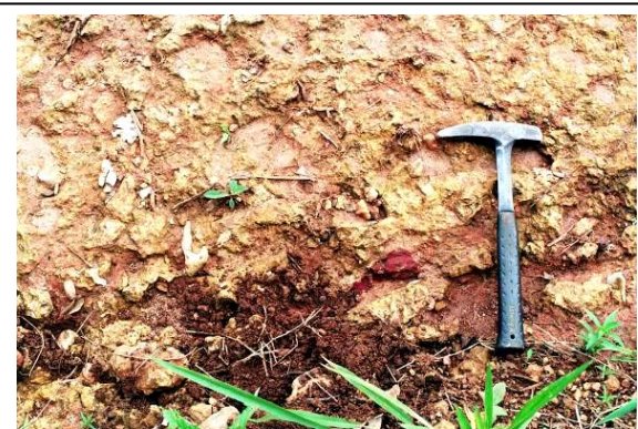
Foto 3.6.3.2-22 - Ponto 321: laterita detrítica, com raros seixos de quartzo, recobrendo o terreno acima do barranco do rio Cabixi, correspondente às Coberturas Sedimentares Indiferenciadas.
