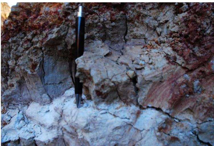
**Foto 8.1.5-6** – Detalhe de *slikenside*, feição desenvolvida por fricção entre as camadas do gnaíse intemperizado. Compreende blocos de argila de atividade alta e rachaduras devido à expansão e contração desse material
