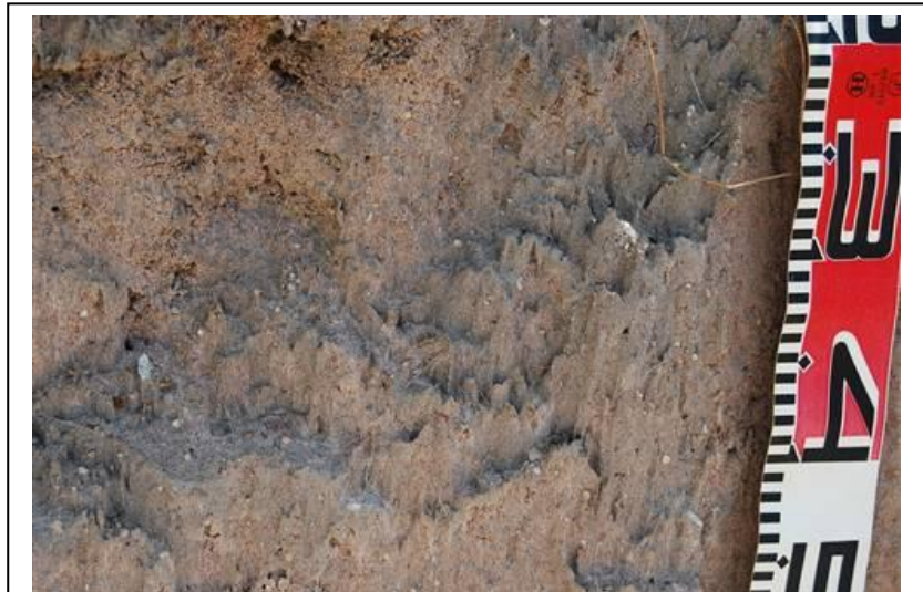
Foto 8.1.3-2 – Solo coluvionar com fragmentos de origens diversas, inclusive material antrópico (cerâmica)
