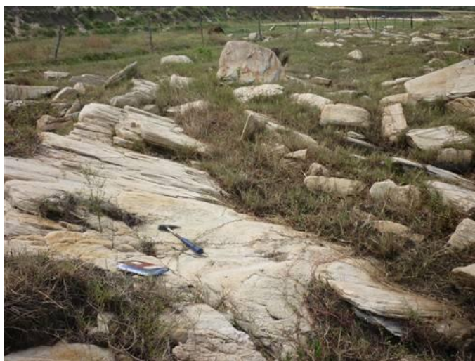
Foto 8.1.3-11 – Leucogranito (quartzolito) fraturado. Notam-se três direções de fraturas
