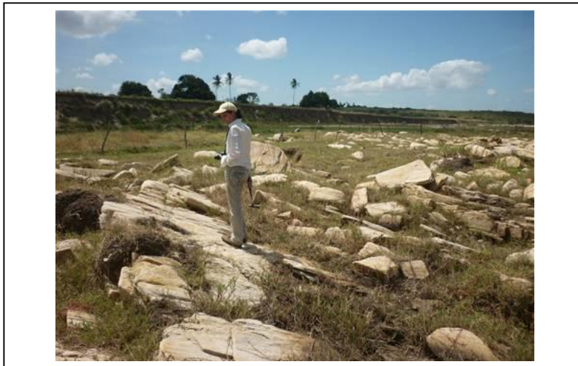
Foto 8.1.3-2 – Solo coluvionar com fragmentos de origens diversas, inclusive material antrópico (cerâmica)
