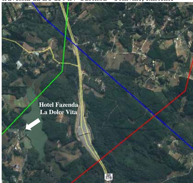
Figura 5.1.2.3.r Interferência com hotel fazenda de grande porte evitada na Alternativa 2 e travessia da LT 230 kV Curitiba – Joinville, existente
