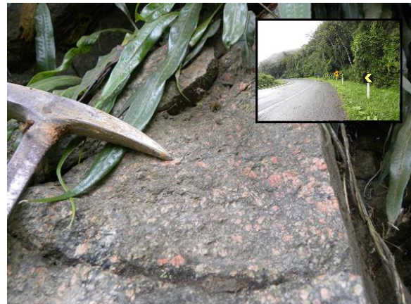
Foto 5.3-2: Caracterização de rocha diorítica, holocristalina, de granulometria média, porfírica, mesocrática, correlacionada aos Ortognaisses Pomerode, encontrada na região de Caminho Pequeno, ao longo da BR 280 (ver detalhe), município de Corupá/SC. Coord.: 22 J 669203 m E 7079876 m S.
