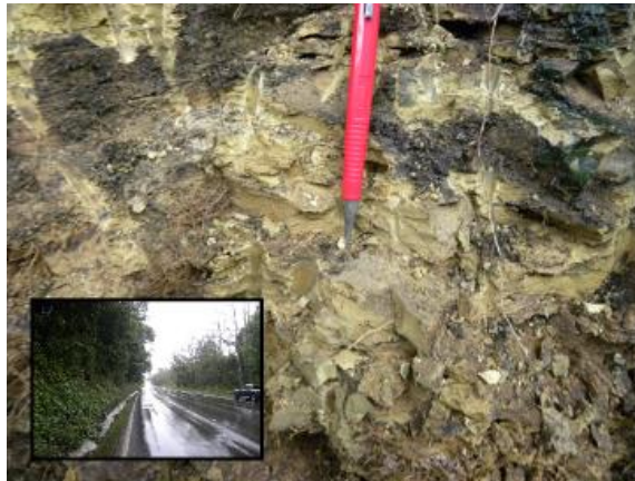
Foto 5.3-19: Detalhe de argilito saprolitizado, de coloração amarelada, mostrando estratificação (espessura variando de 1 a 5 cm) plano-paralela, correlacionado à Formação Rio do Rastro, observado na margem da BR 476 (ver detalhe), na região de Vera Guarani, no município de Paulo Frontin/PR. Coord.: 22 J 528695 m E 7118202 m S.
