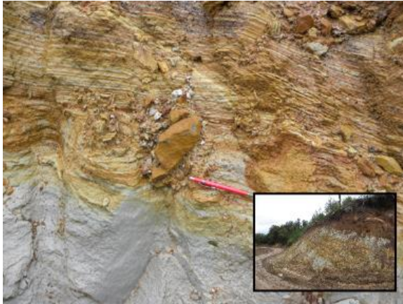
Foto 5.3-5: Detalhe de arenito laminado (com espessura entre 0,5 e 3 cm), de coloração amarelada, granulação fina, grãos bem selecionado, apresentando estratificação plano paralela, sobreposto a arenito argiloso de coloração esbranquiçada, mal selecionado, compondo um estrato exposto com cerca de 0,70 a 1,00 m de espessura, associado à Formação Botucatu. Registro observado na borda da Serra Geral, em estrada vicinal (ver detalhe) na região de Colônia Marcela, porção oeste do município de Mallet/PR. Coord.: 22 J 508390 m E 7131124 m S.
