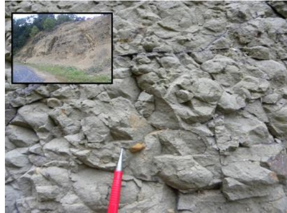
Foto 5.3-14: Caracterização de diamictitos, de matriz arenítica, imatura, de granulação média, apresentando uma coloração acinzentada, com clastos de quartzo distribuídos aleatoriamente nesta matriz, com dimensões entre 1 e 3,5 cm, subarredondados. Rocha correlacionada à Formação Taciba, identificada em talude junto a rua Carlos R. (ver detalhe), na cidade de Rio Negrinho/SC. Coord.: 22 J 648269 m E 7096573 m S.
