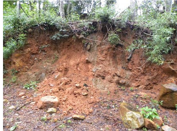
Foto 5.3-87: Instabilização de pequenos volumes de material heterogêneo (solo e blocos de rocha), típicos destes terrenos, conforme observado em taludes de corte na região de Pinhalzinho, município de Cruz Machado/SC. Coord.: 22 J 457909 m E 7134015 m S.
