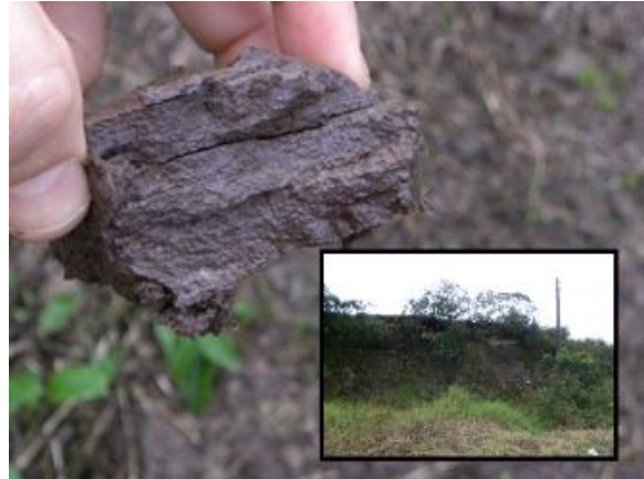
Foto 5.3-18: Siltitos de coloração avermelhada, mostrando, em amostra de mão, um aspecto laminado, definido pela variação de granulometria (silte e argila) destes sedimentos, compondo um pacote tabular (ver detalhe) subhorizontalizado, observado em talude de corte junto a BR 153, na região de Vicinal Sete, no município de Paulo Frontin/PR. Coord.: 22 J 516147 m E 7123207 m S.
