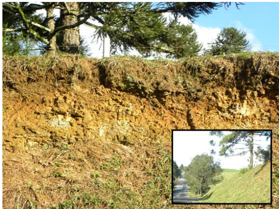
Foto 5.3 45: Caracterização do horizonte superficial A de um perfil típico do cambissolo háplico, de coloração brunada, pouco espesso, sobreposto a horizontes R caracterizado junto a um talude na BR-280, região do rio Lajeado, município de Mafra/SC. Coord.: 22 J 623532 m E 7101249 m S
