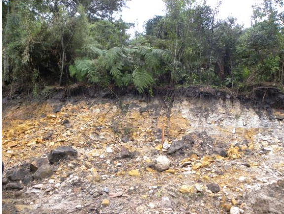
Foto 5.3-55: Neossolo litólico húmico, com sequência de horizontes A superficial húmico (enriquecido de matéria orgânica), sem horizonte intermediário e sobreposto a rochas areníticas da Formação Botucatu (horizonte R S).olo pouco espesso, imaturo, presente na região de Colônia Santa Helena, município de União da Vitória/PR. Coord.: 22 J 507138 m E 7129776 m S.
