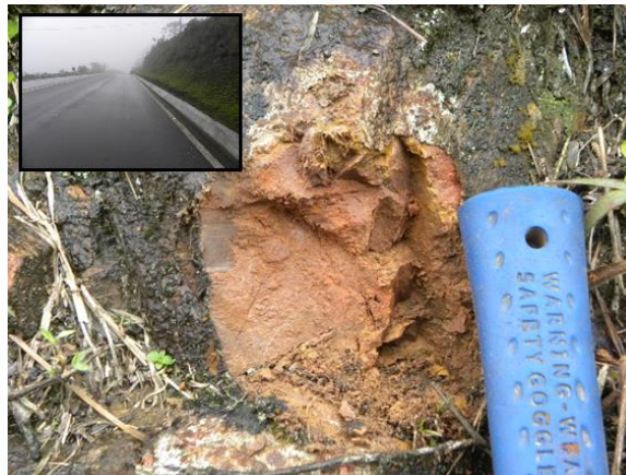
Figura5.3-7: Caracterização de traquito saprolitizado; rocha vulcânica, de textura afanítica, de aspecto maciço, compacta, correlacionada à litofácies de traquito e quartzo-traquito da Formação Campo Alegre, observada em talude nas margens da BR 280 (ver detalhe), na região de Granja Rocha, município de São Bento do Sul/SC. Coord.: 22 J 662032 m E 7085659 m S.
