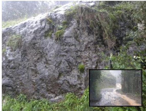
Foto 5.3-35: Afloramento de rocha basáltica, maciça, de textura fanerítica fina, de coloração cinza-esverdeada escura, compondo derrame basáltico com uma exposição aflorante de 6 m, associado ao Membro General Carneiro, observada em talude de corte em estrada vicinal (ver detalhe) na região de Palmeirinha, porção central do município de Cruz Machado/PR. Coord.: 22 J 484633 m E 7124211 m S.
