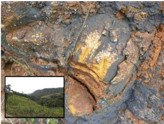
Foto 5.3-33: Basalto maciço com evidente processo de alteração evidenciado pela marcante coloração amarelada e substituição da mineralogia original. Afloramento que mostra o desenvolvimento do processo de esfoliação esferoidal, correlacionado ao Membro General Carneiro, conforme observado na região de Água Branca (ver detalhe), nas proximidades do rio da Areia, município de Pinhão/PR. Coord.: 22 J 453395 m E 7131966 m S.
