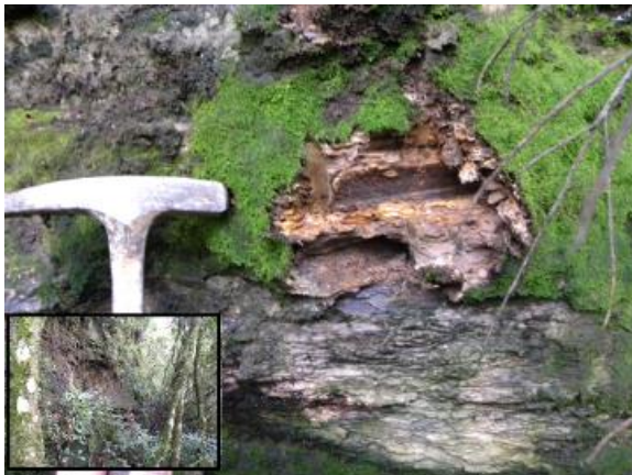
Foto 5.3-24: Detalhe de folhelhos de coloração preta, mostrando uma foliação bem marcada, de textura síltica-argilosa associada aos litótipos da Formação Irati, observados em talude de corte (ver detalhe) na rua 192, área urbana de Três Barras/SC. Coord.: 22 J 569085 m E 7112847 m S.
