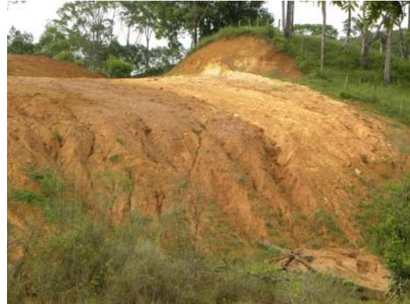
Foto 5.3-70: Evidências de erosão linear rasa sobre material saprolíticos de textura argilo-arenosa, friável, cuja concentração de água na superfície descoberta do terreno, associada à variação de declividade local, favoreceu o aparecimento e evolução do processo erosivo observado na região de Dedo Grosso, zona rural de Joinville/SC. Coord.: 22 J 707661 m E 7080451 m S.
