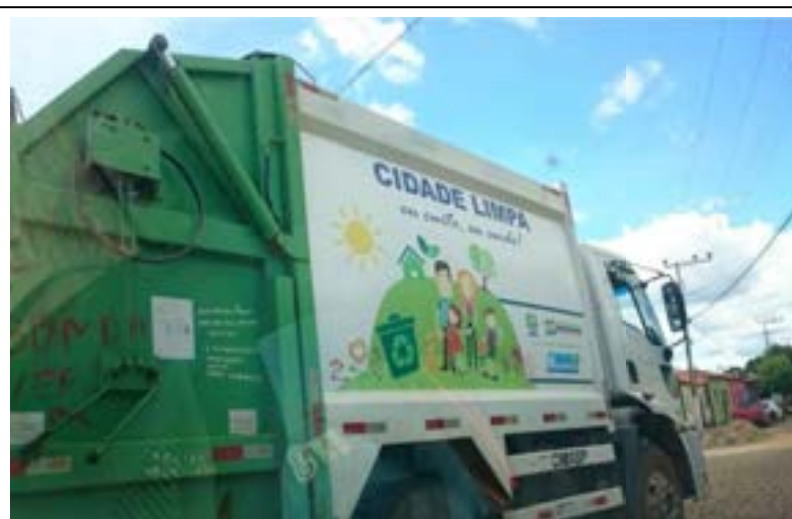
Foto 5.4.2-9 – Caminhão compactador para coleta de resíduos sólidos urbanos no município de Riachão das Neves (BA).
