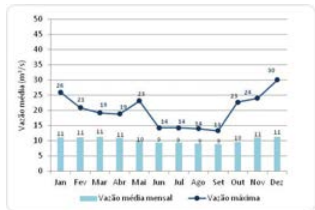
Figura 5.2.2-10: Vazão na estação Foda Velha de Baixo, para o período de 2001 a 2016, com falhas. Fonte: ANA, 2017a.
