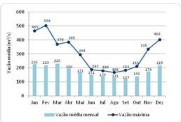
Figura 5.2.2-17: Vazão na estação São Sebastião, para o período de 1986 a 2016, com falhas. Fonte: ANA, 2017 a.
