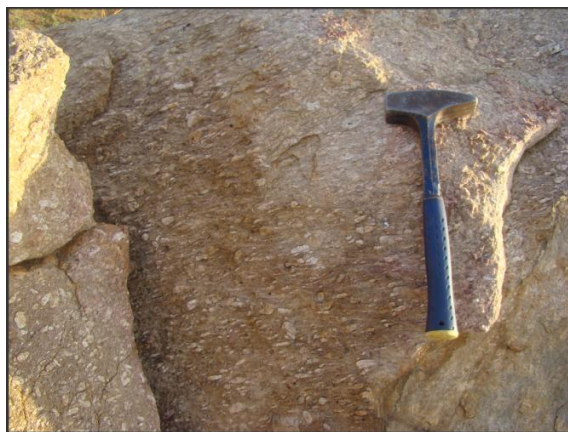
Figura 27 - Granito porfirítico intemperizado onde alguns cristais de K-feldspato estão alterados pra caolinita (Fonte: Bourscheid, abril/2013).
