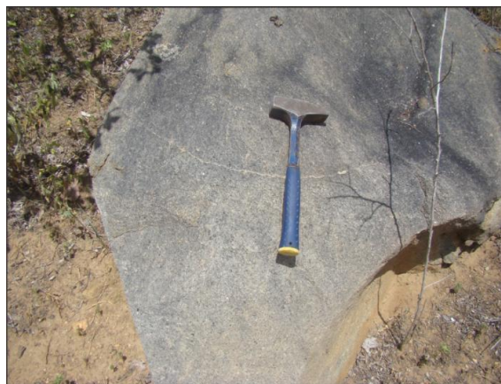
Figura 32 - Diorito equigranular cinza (Fonte: Bourscheid, abril/2013).
