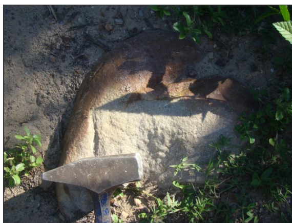
Figura 85 - Arenito fino silicificado (Fonte: Bourscheid, abril/2013).
