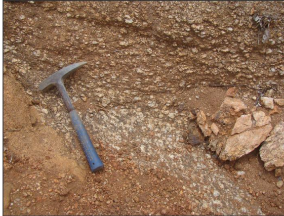
Figura 33 - Granito porfirítico intemperizado onde os cristais de K-feldspato alterados para caolinita (Fonte: Bourscheid, abril/2013).
