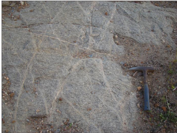
Figura 38 - Vista geral do afloramento mostrando os vários veios graníticos que cortam a rocha (Fonte: Bourscheid, abril/2013).
