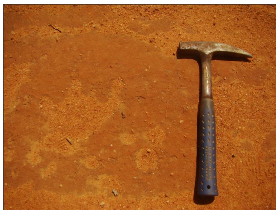
Figura 3 - Arenito grosso com grânulos angulosos de quartzo (Fonte: Bourscheid, abril/2013).
