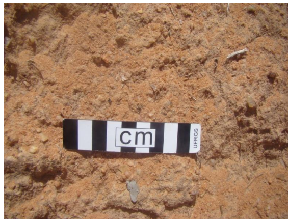
Figura 8 - Arenito conglomerático bastante alterado (Fonte: Bourscheid, abril/2013).
