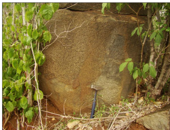
Figura 34 - Granito equigranular médio (Fonte: Bourscheid, abril/2013).
