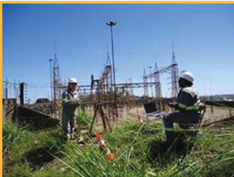
Exemplo de monitoramento dos campos elétrico e magnético
