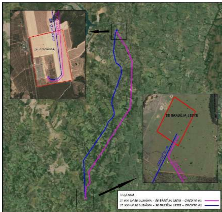
Figura 244 - Localização do Traçado da LTs 500kV Luziânia - Brasília Leste e da Subestação Brasília Leste
