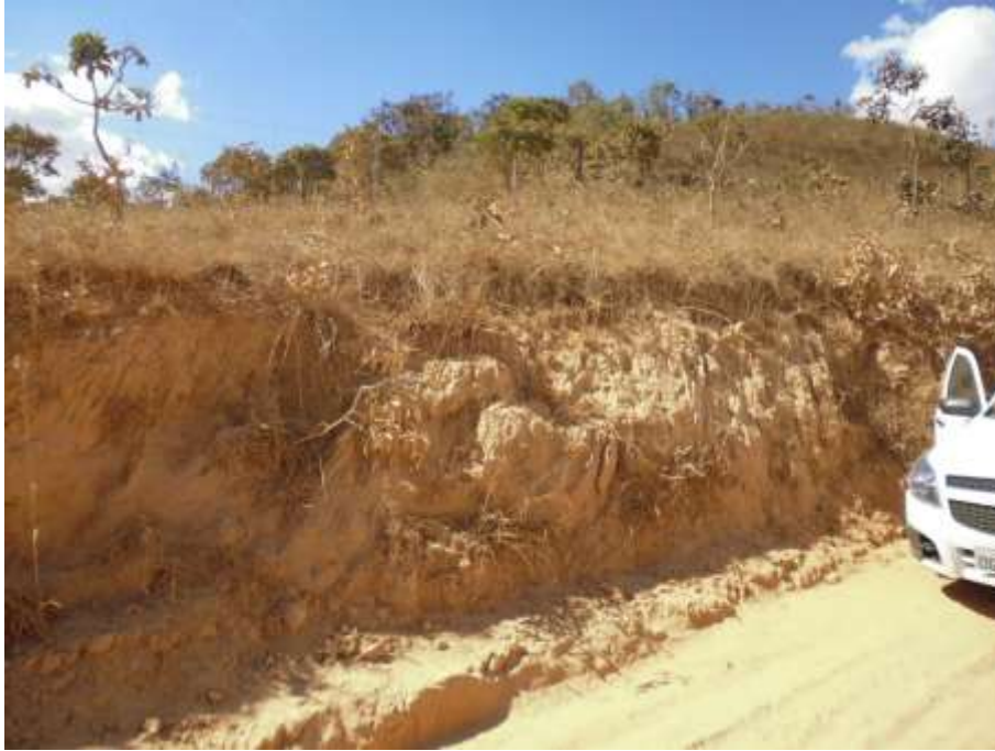
Figura 62 - Corte em estrada, onde evidencia-se o Cambissolo pouco desenvolvido com grande quantidade de material siltoso e pedregosidade (UTM Fuso 23K 210.427E / 8.220.014N – 860m)
