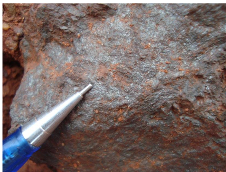
Figura 48 – Formação ferrífera bandada de granulação muito fina.
