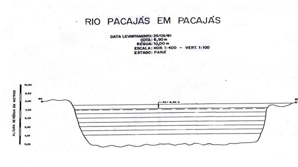
Figura 6.2-32 - Perfil transversal da seção de medição no rio Pacajás.
