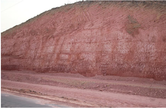
Foto 4.2.9-2: Plintossolo Pétrico observado em corte de estrada próximo ao município de Goianésia do Pará - PA (Ponto TC-75, Tabela 4.2-1).
