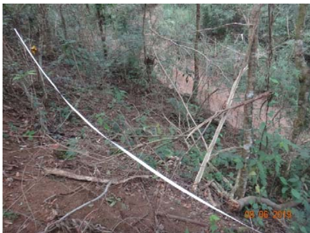
Foto 25: Parcela 48 — Delimitação da parcela com o uso de trena de 50 metros. Nota-se solo argiloso.
