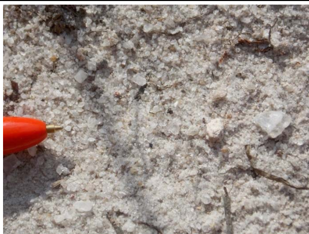
Fotos 11 e 12: Areias mal selecionadas finas, médias e grânulos de quartzo e argilas cinza maciças que constituem as Planícies fluviais, que são terrenos de Sensibilidade Geoambiental Alta, devido ao risco de inundação, contaminação e assoreamento.
