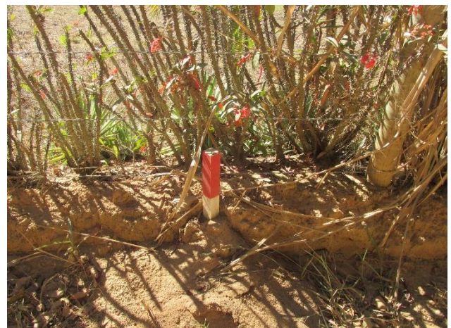
Foto 0334: Detalhe do marco topográfico do traçado da LT 500 kV Campos 2 - Mutum.
