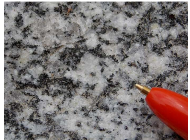
Fotos 81 e 82: Extenso afloramento rochoso explorado como pedreira, formada por granitoides foliados a gnáissicos, metaluminosos, calcialcalinos, tipo 1 (Tonalito Galileia), que ocorrem nos terrenos Montanhosos e Escarpados.
