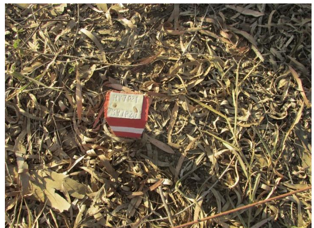
Foto 0312: Detalhe do marco do traçado da LT 500 kV Campos 2 - Mutum.
