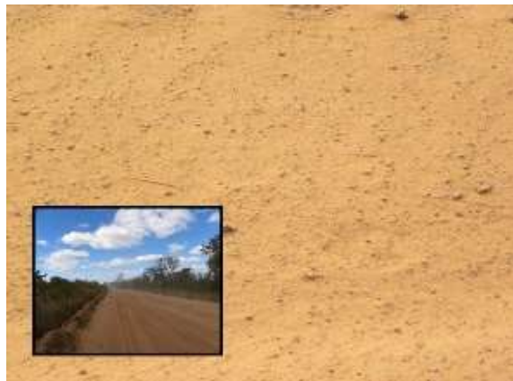
Foto 5.2-212: Caracterização da textura arenosa, de granulação média, associada aos neossolos quartzarênicos. Coord. 23 L 400.096 m E, 8.241.124 m S.
