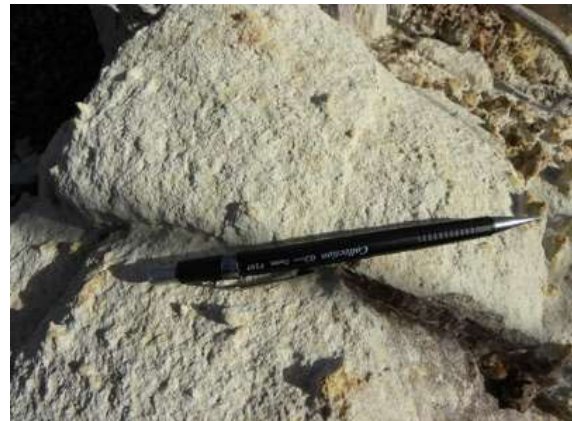
Foto 5.2-60: Rocha do tipo diamictito, típica do Grupo Santa Fé, conforme observado em parte da área a ser interceptada pela LT.
