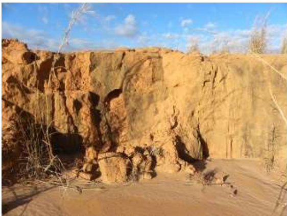
Foto 5.2-190: Corte do terreno, com exposição de perfil pedológico de latossolo vermelho-amarelo. Coord. 23 L 372.693 m E, 8.468.340 m S.
