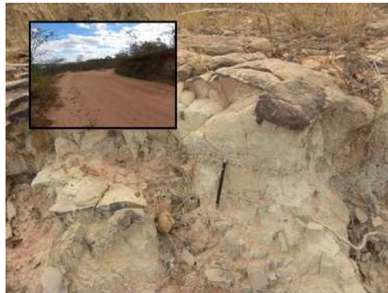
Foto 5.2-56: Diferenciação do arenito associado ao Grupo Areado, de coloração esbranquiçada, granulação fina, bem selecionado.
