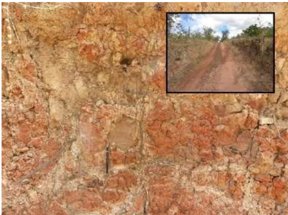
Foto 5.2-59: Detalhe do diamictito saprolitizado com blastos subangulosos de materiais diversos, dispostos numa matriz argilosa.
