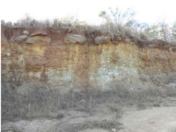
Foto 5.2-239: Topo rochoso com presença de matacões dificultando a escavabilidade local. Coord. 23 L 376.978 m E, 8.399.924 m S.
