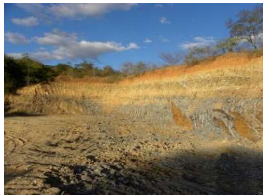
Foto 5.2-226: Exposição de Argissolo Vermelho Amarelo Háplico em talude de corte. Coord. 23 L 376.998 m E, 8.399.914 m S.
